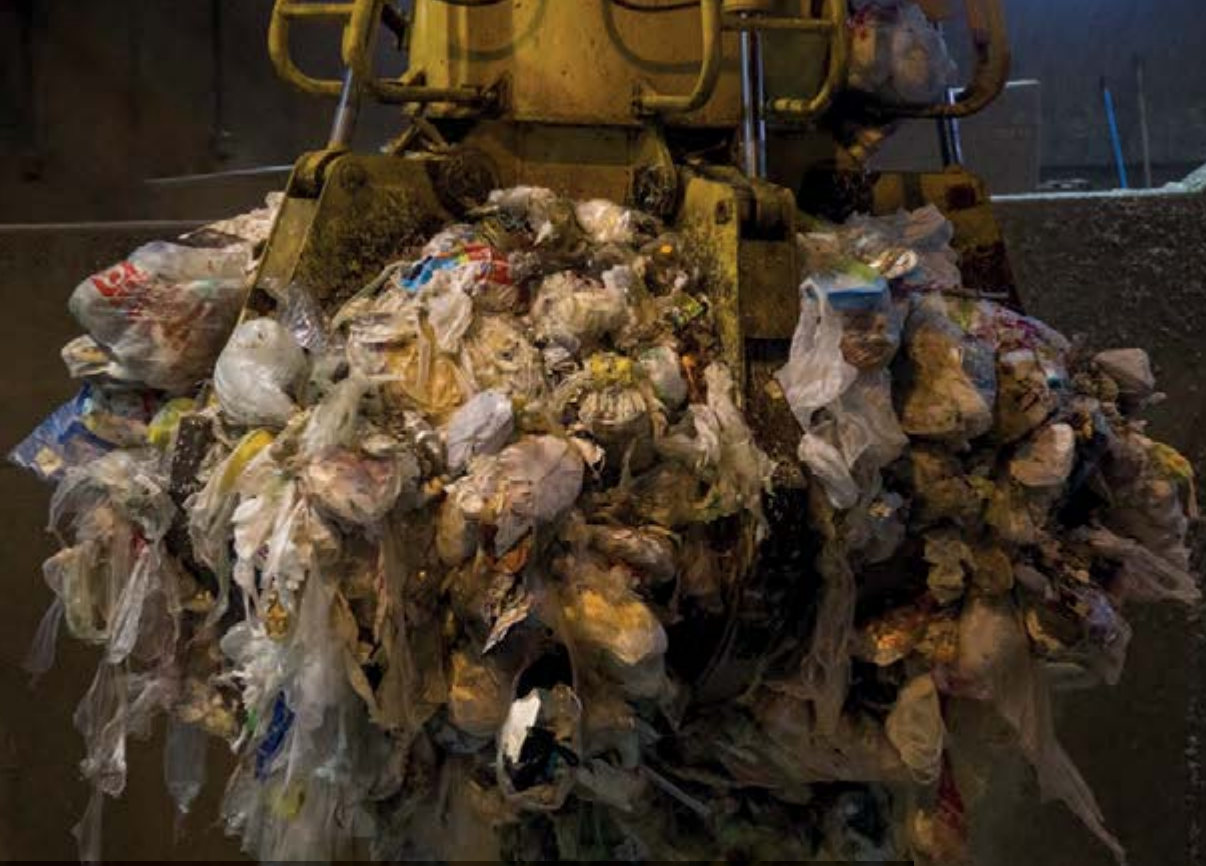
Huge claws of the refuse crane of the full expansion about four meters pick up about 2 ton garbage. 広げると約4メートルになるごみクレーンの爪が重さ約2トンのごみをつかみ上昇中。
